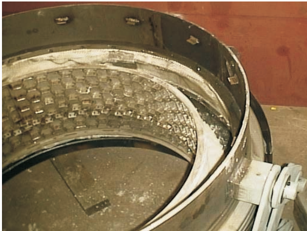
Kompensator für Raffinerie Exxon/Mobil Kompensator inklusive Ausmauerung und Scherengelenke Balg aus Inconel 625
