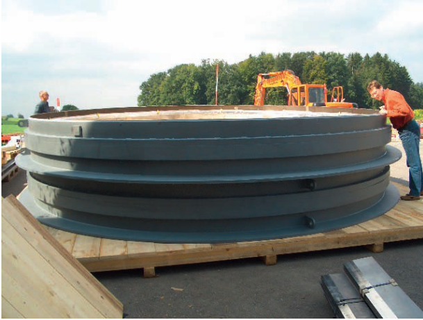
Axial Kompensator DN 5520 für Kühlanlagen Axial expansion joint DN 5520 for cooling systems
