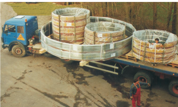
Grosskompensator DN 6450 mehrschichtig Verpackt für LKW Transport. Big multiply expansion joint DN 6450, ready for transportation.
