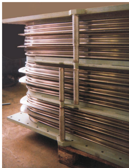
Mehrschicht Rechteckkompensator DN 2667 x 546 mm Bauhöhe 980 mm, Axialhub 720 mm Mutliply rectangular expansion joint DN 2667 x 546 Fabric length 980 mm, Axial mov. 720 mm
