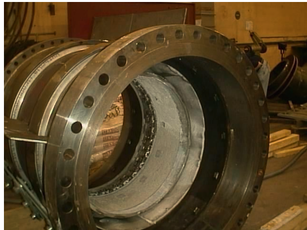
Kompensator für Raffinerie Exxon/Mobil Kompensator inklusive Ausmauerung und Scherengelenke Balg aus Inconel 625
