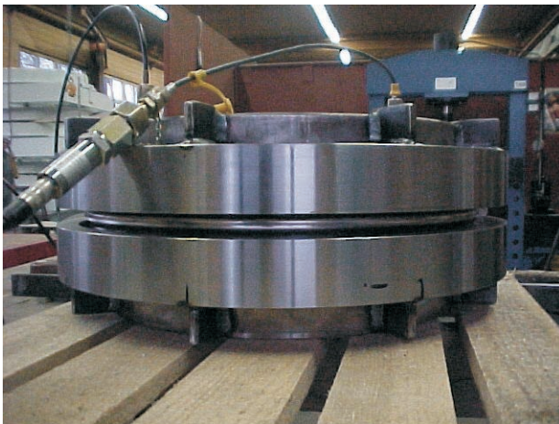
Hochdruckkompensator für Vöst Alpine Stahl DN 450 Testdruck 750 bar
