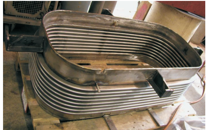
Mehrfachwandiger Rechteckkompensator 1400 Zyklen mit 170 mm Axialhub
