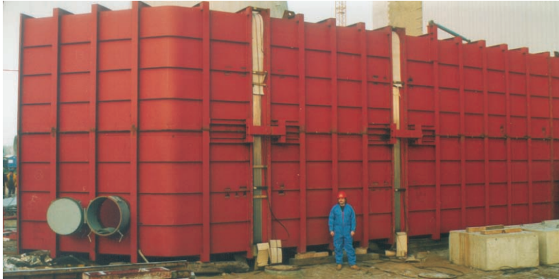
Mehrschicht Rechteckkompensator DN 8000 x 3000 mm Rauchgasleitung thermisches Kraftwerk
