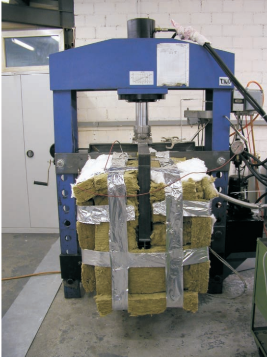
Lebensdauerversuch Hochvacuum und Temperatur 150°C
