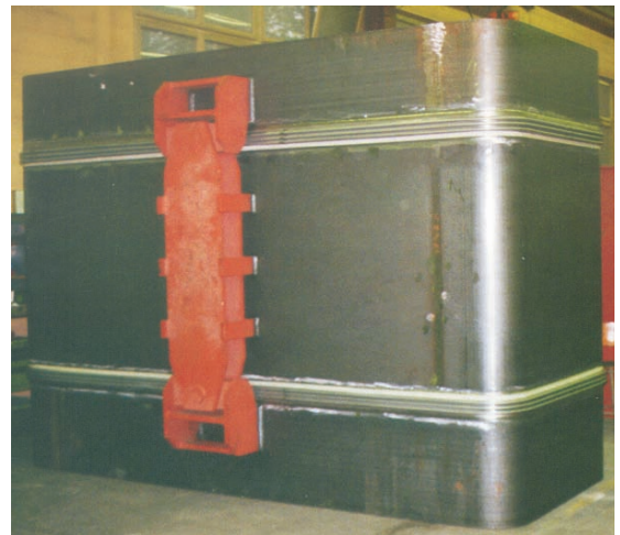
Rechteckkompensator zum Einbau nach der Turbine mit Lateralverspannung. Druck +/- 1 bar.
